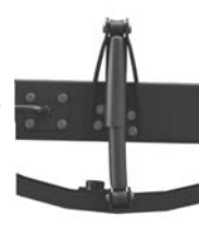
Empenos nas fixações do veículo podem impedir o perfeito funcionamento do amortecedor
