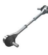
Avarias (empenos) na barra estabilizadora e/ ou tirantes de ligação (bieleta) podem reduzir ou impedir o curso de funcionamento do amortecedor
